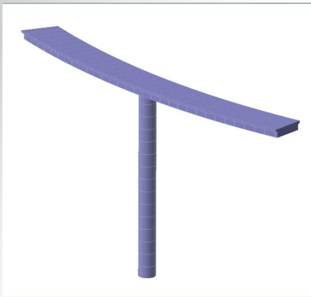
某钢筋混凝土弯桥（带独柱墩）模型示意图 跨径16m+16m，R=100m，墩高15m，D=1.5m
